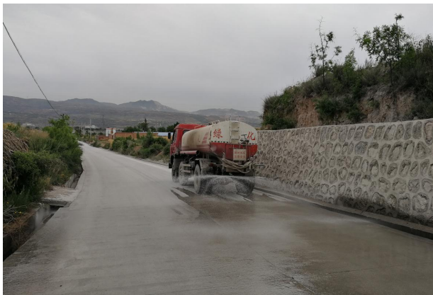
照片 2-16 矿山洒水除尘
