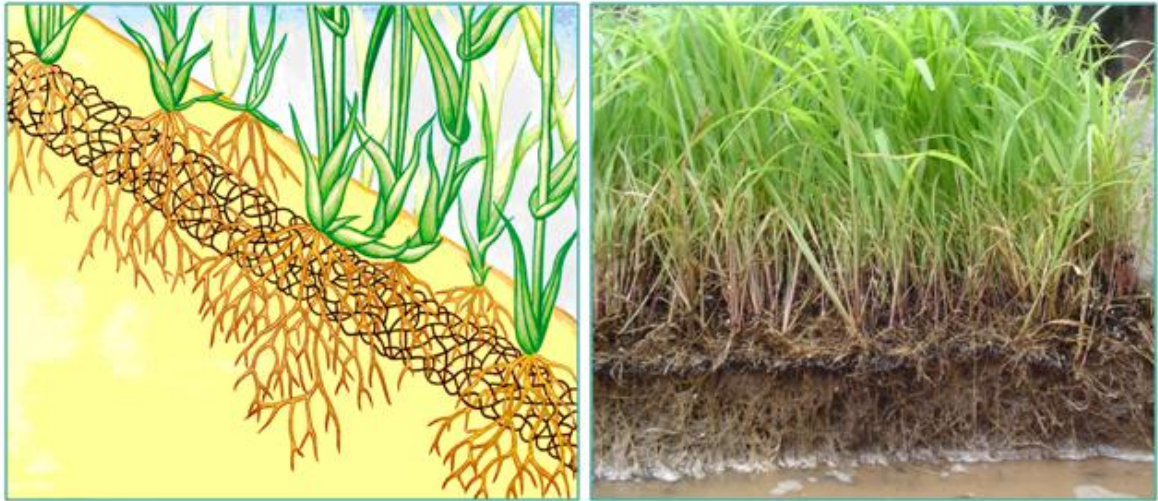
图 5-5 加筋麦克垫防护示意图
